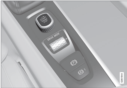
Disco de arranque na consola de túnel.
