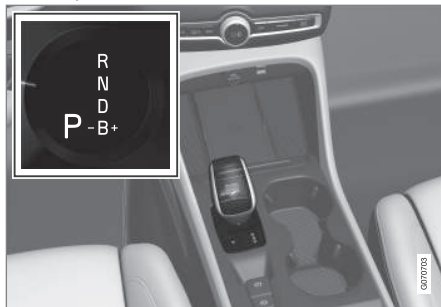
Panorâmica geral de alavanca das mudanças e padrões de mudanças no mostrador do condutor.
