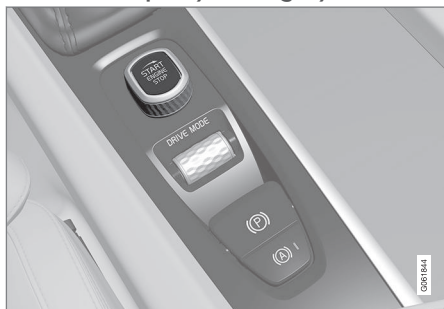
Disco de arranque na consola de túnel.
