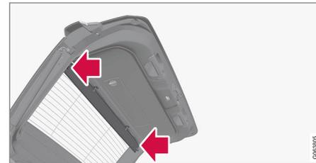
Vire o painel de cobertura corretamente com o lado de aparafusar para baixo e alinhe o pino no suporte em um lado da tampa do porta-malas.
