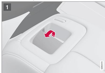
Em veículos com rebatimento do apoio de cabeça controlado eletronicamente\*, os apoios de cabeça laterais podem ser descidos utilizando a alça no lado superior do banco, consulte a figura **1**. Observe que esse método também rebate os encostos. Se somente os apoios de cabeça devem ser rebatidos, por exemplo, para melhorar a visibilidade, isso pode ser feito no visor central\*.
