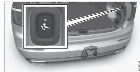
Abra a tampa do porta-malas. Na parte de trás do painel lateral direito da área de carga existe um botão para retração e rebatimento da barra de reboque. Para que a função de rebatimento esteja ativa é necessário que esteja acesa uma luz indicadora laranja no botão.
