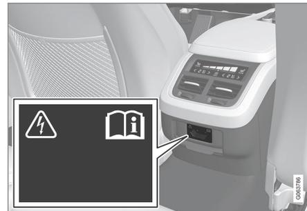
Tomada elétrica no console de túnel, banco traseiro.
