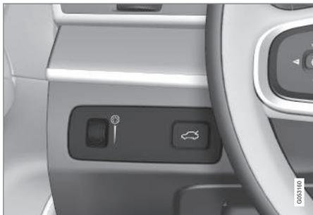
O seletor rotativo (à esquerda) para ajuste da intensidade da luz interior.
