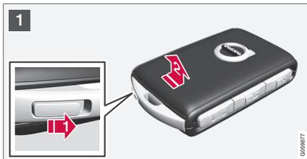
1 **1**▶ Segure a chave do controle remoto com a frente visível e o logo da Volvo para o lado direito. Deslize o botão na extremidade de baixo do anel da chave para a direita. Leve a proteção lateral dianteira alguns milímetros para cima.
