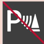
Preste muita atenção ao andar na marcha à ré quando esse símbolo for exibido se um reboque, um suporte para bicicleta ou similar estiver montado e conectado eletricamente
