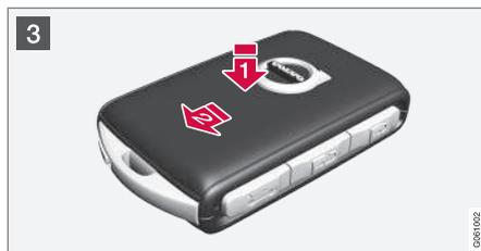
3 Recoloque a lâmina da chave em sua posição na chave do controle remoto depois de usar.
