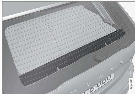
Ao utilizar a tampa da carga, deve-se montar um painel de cobertura na tampa do porta-malas.
