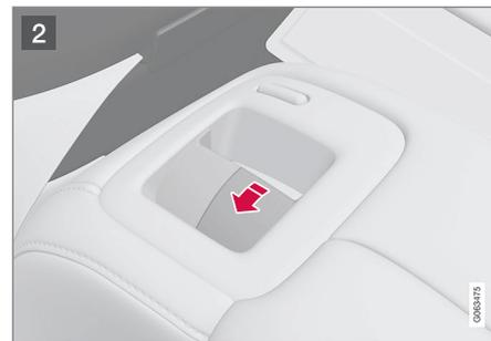
Para veículos sem rebatimento eletrônico, desça manualmente os apoios de cabeça laterais com o controle interior no lado de cima do banco, veja a imagem **2**.
