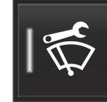
Pressione o botão **Pos. serviço do limp. para-brisa**. O indicador luminoso no botão acende quando o modo de serviço está ativado. Quando ativados, os limpadores se movem para a posição de serviço. Para desativar o modo de serviço, pressione uma vez em **Pos. serviço do limp. para-brisa**. O indicador luminoso no botão apaga quando o modo de serviço está desativado.
