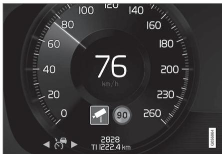
Exemplos de informação sobre radares fixos de velocidade e limite de velocidade no visor do motorista
