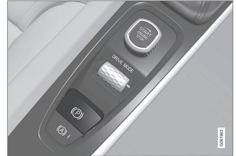
O controle do freio de estacionamento está localizado no console do túnel, entre os bancos.
