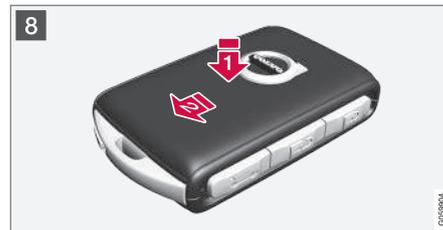
**8** **1** Gire a chave do controle remoto e reinstale a proteção lateral dianteira pressionando-a até ouvir um clique.
