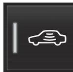
Pressione o botão **Proteção reduzida** na visualização de função do visor central para desligar os sensores de movimento e inclinação quando for trancar o veículo.
