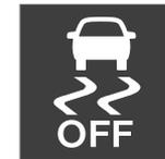
O visor do motorista indica ativado **Modo esportivo ESC** exibindo este símbolo com brilho constante até que a função seja desativada ou que o motor seja desligado. A próxima vez que o motor for
