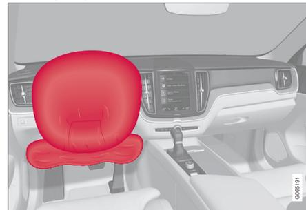
Airbag do volante e airbag do joelho<sup>1</sup> no lado do motorista no banco dianteiro.
