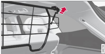
Coloque a as fixações da grade de proteção nas fixações do teto.
