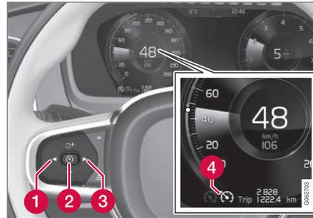
Para iniciar o cruise control a partir do modo de espera, a velocidade atual do veículo deve ser de no mínimo 30 km/h (20 mph).
