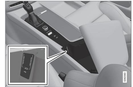
Entradas USB (tipo A) no console de tûnel. Colocar os cabos para frente, para não ficarem presos ao fechar a tampa.
