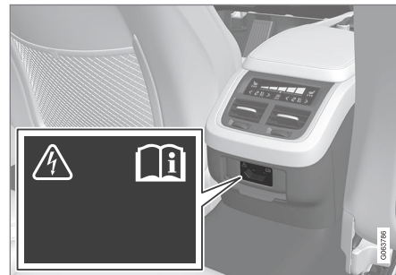
Stroomaansluiting in tunnelconsole, achterin.
