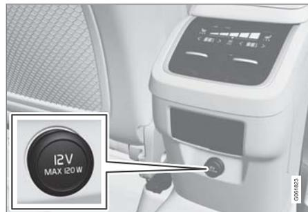
トンネルコンソールの 12V 電源ソケット(リアシート)
