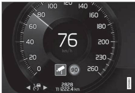
ドライバーディスプレイのスピード違反取り締まりカメラと制限速度に関する情報の例
