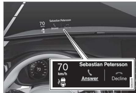
ヘッドアップディスプレイは、速度、クルーズコントロール機能、ナビゲーションシステムなどに関する警告および情報を運転者の視野の中に表示します。ヘッドアップディスプレイには、ロード・サイン・インフォメーションや電話の着信も表示できます。
