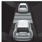
車間時間は、距離シンボルが車両2台を表示しているときのみ、前方の車両を対象にしてアダプティブクルーズコントロールにより調節されます。同時に速度範囲がマークされます。
