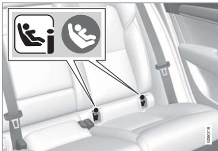
マウンティングポイントの位置はバックレストカバーのシンボル<sup>2</sup>で示されています。
