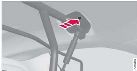
付属のスクリューを挿入し、付属の6 mm六角棒レンチを使用して締め付けます。反対側で同じ作業を繰り返します。推奨締め付けトルク：20 Nm (15 ft-lbs)
