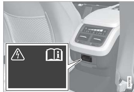
トンネルコンソールの電源ソケット(リアシート)
