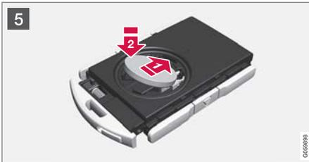
5 (+)側を上に向けて、新しい電池を取り付けます。リモートコントロールキーの電池接点を指で触らないようにしてください。
