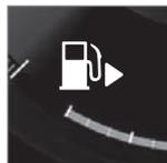
ドライバーディスプレイでは、タンクシンボルの横にある矢印が車両のどちら側に燃料給油口フラップがあるかを示しています。
