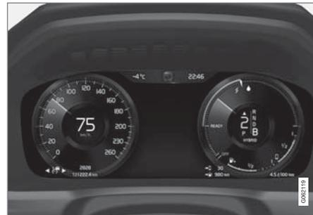
ドライバーディスプレイには、速度や電話の着信、再生中の曲に関する情報が表示されます。ディスプレイの操作には、ステアリングホ
