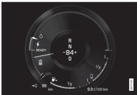
電動モーターによるブレーキ時には、ドライバーディスプレイに充電が表示されます。
