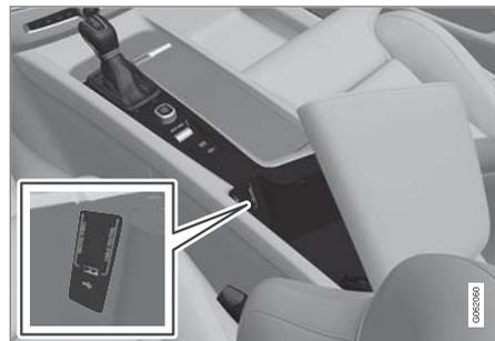
トンネルコンソールの USB ポート (A タイプ) リッドを閉めるときにははさまれないように、USB ケーブルは前方にくるよう配置してください。
