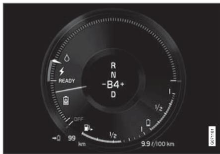
車両は発電し、バッテリーに充電されます(例：ブレーキペダルを軽く踏み込むとき、または下り坂でエンジンブレーキが作動しているとき)。
