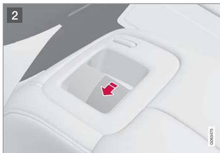
電動可倒機能が装備されていない場合、ドア側ヘッドレストはシート上部の内側のコントロールボタンを使用して手動で倒します。図 2 を参照してください。
