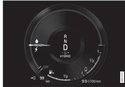
ハイブリッドゲージは、電動モーターからの出力の使用量と使用可能な出力の関係をさまざまな方法で表示します。
