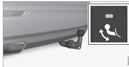
トウバーを最終位置まで動かします。トウバーは所定の位置で固定およびロックされます。インジケータランプがオレンジ色で点灯します。
