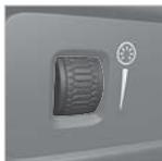
ディスプレイの照明、コントロールの照明、アンビエントライトおよびインテリアシアターライト\*の調節には、メーター・パネルのコントロールダイヤル(ステアリングホイールの左)を使用します。
