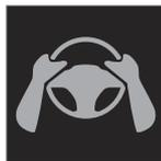
Pilot Assistにより、運転者が両手でステアリングホイールを握っていないことが検知されると、車両を能動的に操舵するよう促すために、シンボルとテキストメッセージの警告がドライバーディスプレイに表示されます。
