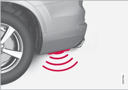
スキッドプレート装備車両で、足の動きによって開閉するには、車両のサイドからキックをするような動作をします。開閉するためには、車両のリモートコントロールキーの内1個が車両の作動範囲内(約1 m (3 ft))にある必要があります。
