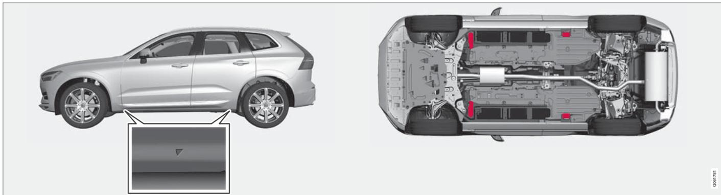
プラスチックカバーの三角マークは、取り付けポイントの場所を示しています(赤で表示)。
