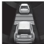
先行車両との車間時間は増減させることができ、1~5本の横線によってドライバーディスプレイに表示されます。線の数が多いほど、車間時間が長くなります。横線が1本であれば、前方の車両まで約1秒であることを示し、横線が5本あれば、約3秒であることを示します。
