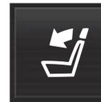
**ヘッドレストを倒す** ボタンを押して、ヘッドレストを倒す操作をオン/オフにします。
