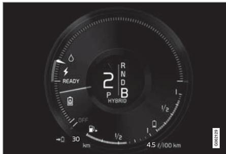
車両がバッテリーに電流を生成し、バッテリーが充電されます(例: ブレーキペダルが軽く踏み込まれたとき、または下り坂でエンジンブレーキが作動しているとき)。
