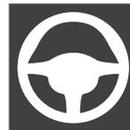
出力が制限されると、ドライバードisplayに **パワーステアリング アシストが一時的に低下しています** というメッセージと、このシンボルが表示されます。
