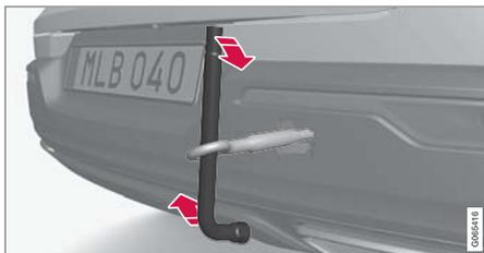
けん引フックを確実にねじ込みます。例えば、ホイールレンチ\*を輪に通して、てこの原理で締めつけます。
