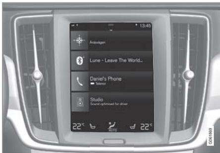
車両の主要機能の多くは、センターディスプレイから操作します。センターディスプレイはタッチ画面です。したがって、車内のボタンおよびスイッチ類の数は最小限に抑えられています。画面は手袋を着用しているときでも操作することができます。
