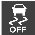
ドライバーディスプレイは、機能が解除されるか、エンジンを停止するまで、このシンボルを点灯させることにより **ESC スポーツモード** が起動していることを示します。次のエンジン始動時は、システムは通常モードに戻ります。
