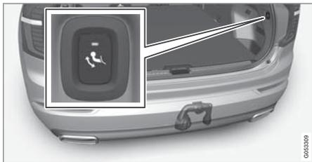
テールゲートを開きます。トウバーの引き出し/格納用ボタンはカーゴスペース後部の右側にあります。引き出し機能を作動させるには、ボタンのインジケータがオレンジ色で点灯している必要があります。
