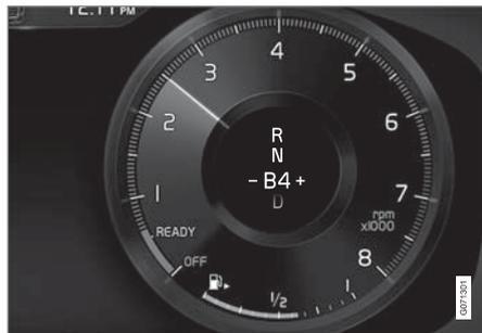
マニュアルギヤシフトモードで、ステアリングホイールパドルによりギヤをシフトしているときのドライバーディスプレイ
