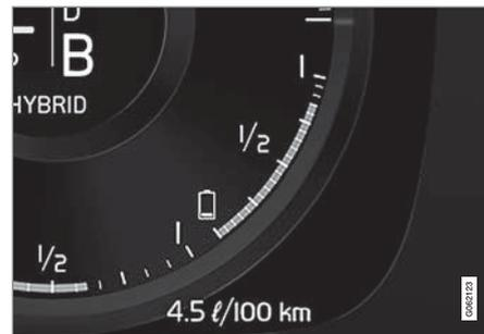
ハイブリッドバッテリーのエネルギーは、電気モーターだけでなく車内の冷暖房にも使用されます。トリップコンピューターはハイブリッドバッテリーに残っているエネルギーで走行可能な概算距離を計算します。
