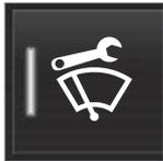
**ワイパーの サービス位置** ボタンをタップします。サービスポジションを起動すると、ボタンの表示灯が点灯します。起動すると、ワイパーがサービスポジションに移動します。
