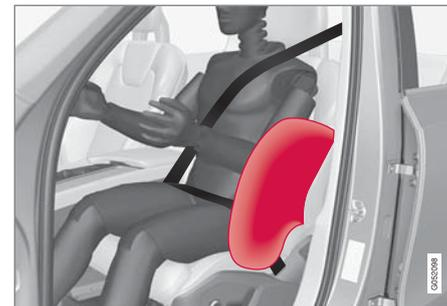
サイドエアバッグはフロントシートの外側バックレストフレームに備えられており、フロントシートの運転者と乗員を保護します。
