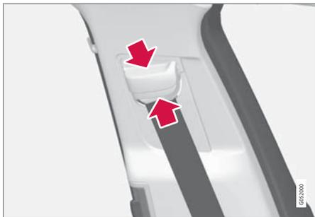
シートマウンティングを押して、シートベルトを上下に動かしてください。
