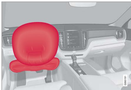
運転席側のステアリングホイール・エアバッグおよびニーエアバッグ<sup>1</sup>
