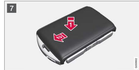
7 1 裏面のカバーを元の位置に戻し、カチッという音がするまで押し込みます。
