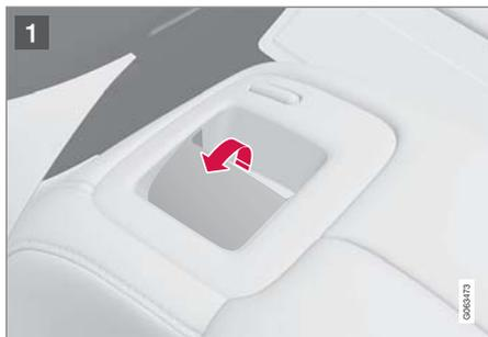
電動可倒式ヘッドレスト\*装備車両では、シート上部のハンドルを使用してドア側ヘッドレストを倒すことができます。図 1 を参照してください。この方法で、バックレストも倒すことができます。視野を広げるなどの理由でヘッドレストのみを倒す場合には、センターディスプレイから操作することもできます\*。
