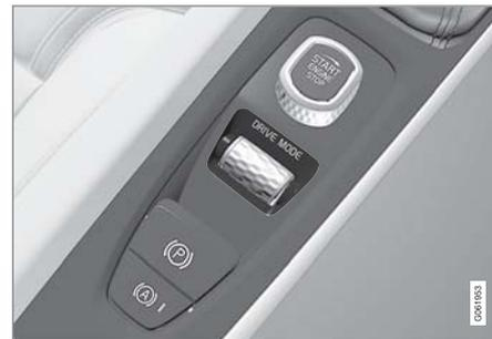
1. ドライブモードコントロールの **DRIVE MODE** を押します。
