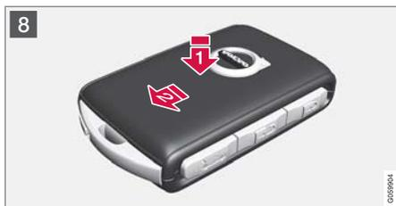
8 **1** リモートコントロールキーを回してカチッという音がするまで押し込み、フロントサイドのカバーに再度取り付けます。
