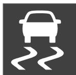
トレーラー・スタビリティ・アシスト(TSA)の作動中は、ドライバードisplayにESCシンボルが点滅します。
