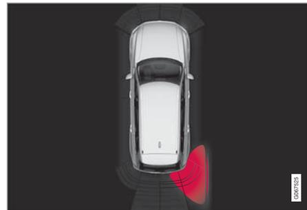
画面の **パークアシストシステム** グラフィックの Cross Traffic Alert アイコン点灯
