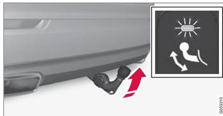
トウバーが引き出され、ロック解除位置まで下がります。インジケータランプがオレンジ色で点滅します。トウバーは引き続きロック位置まで移動できる状態になります。
