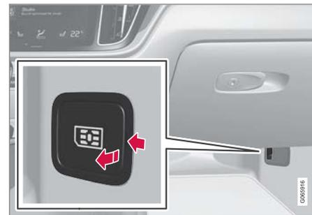
パーソナル SIM カードを助手席側のフロア付近にあるホルダーに挿入します。
