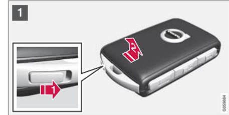
1 **➡** 表面を上にし、ボルボのロゴを正しい方向に向けてリモートコントロールキーを保持し、下端のキーリング近くにあるボタンを右にスライドさせます。表面のカバーを上方向に数ミリずらします。
