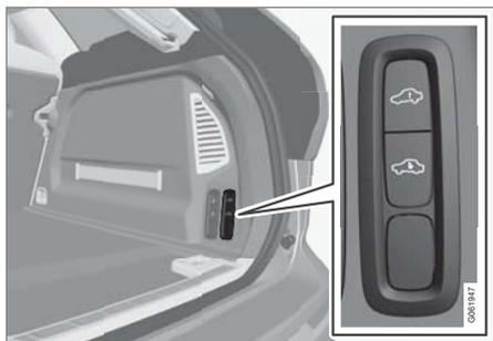
トランクルーム/カーゴスペースのボタンを使用して車両後部の高さを調節すると、荷物の積み下ろしがしやすくなります。トレーラーの接続または切り離しもしやすくなります。
