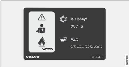
② R1234yf 冷媒仕様車用 A/C システム表示ラベル
