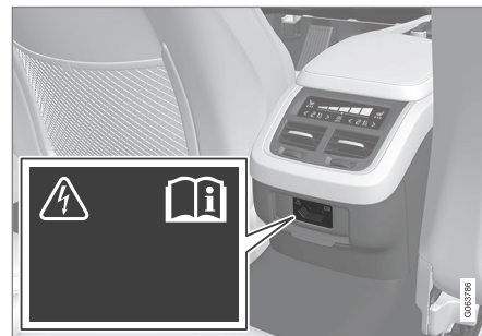
Presa elettrica nel tunnel, sedile posteriore.
