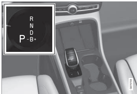
Panoramica della leva selettoria e schema di cambio sul display del conducente.
