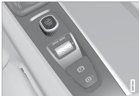
Interruttore di avviamento nel tunnel.
