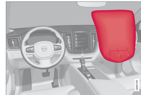
Airbag nel sedile anteriore sul lato passeggero.
