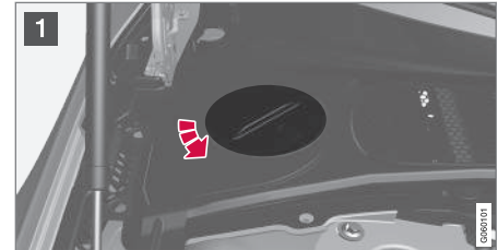
Jäähdytysjärjestelmän paisuntasäiliö, vasemmalta ohjattava auto
