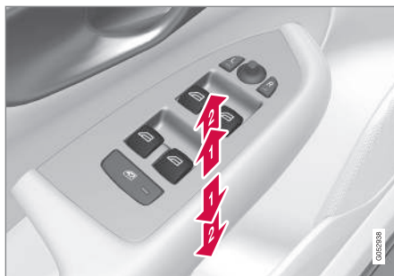
Ikkunannostimien käyttö.
