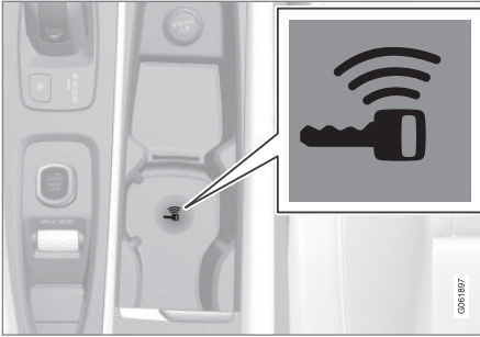
Varmistuskijain sijainti tunnelikonsolissa.
