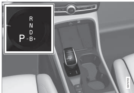
Oversigt over gearstang og gearskiftemønster på førerdisplay.
