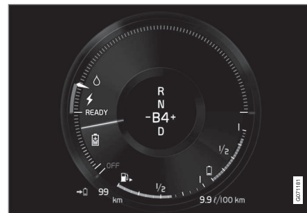
Førerdisplayet angiver opladning under elmotorbremsning.
