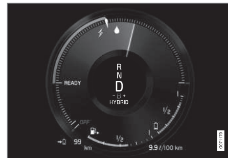
Førerdisplet ved fremdrift med både el- og forbrændingsmotor.
