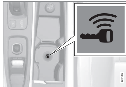
Umístění záložní čtečky v tunelové konzole.
