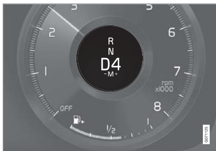
駕駛人顯示器當以小型排檔桿方向盤撥片換檔時。
