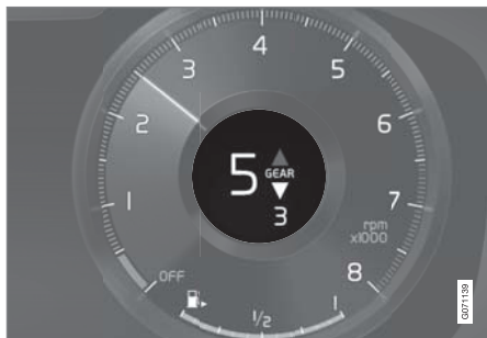
12 吋駕駛人顯示器*中的換檔指示器。
