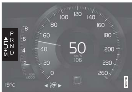
大型排檔桿的 8 吋駕駛人顯示器中的換檔指示器。
