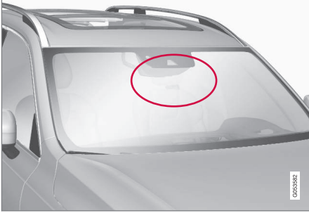
Radar ünitesi konumu
