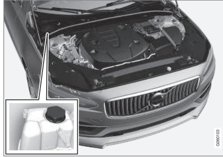
Soğutma sıvısı genişleme kabı, soldan direksiyonlu araç
