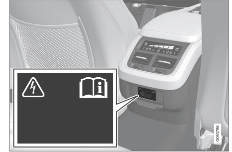
Tünel konsolundaki elektrik soketi, arka koltuk.
