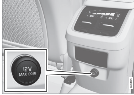
Arka koltuk, tünel konsolundaki 12 V elektrik soketi.
