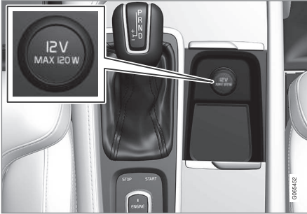
Tünel konsolundaki 12 V elektrik soketi, ön koltuk.
