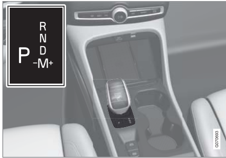
ภาพรวมของคันเกียร์ขนาดเล็กและรูปแบบการเปลี่ยนเกียร์ในจอแสดงผลสำหรับคนขับ
