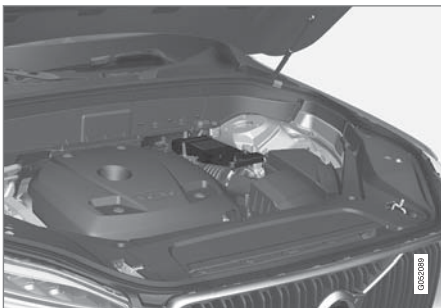
แบตเตอรี่สำรอง 12 โวลต์ จะอยู่ในช่องถัดจากเหล็กค้ำใช้
