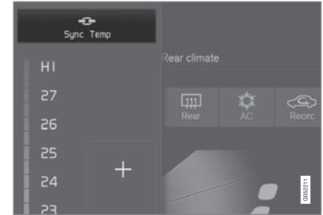
ปุ่มปรับให้เท่ากันบนตัวควบคุมอุณหภูมิด้านคนขับ
