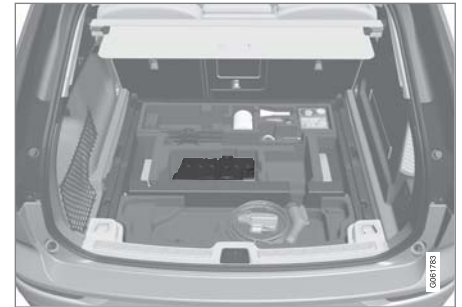
แบตเตอรี่สตาร์ทติดตั้งอยู่ในห้องเก็บสัมภาระ
