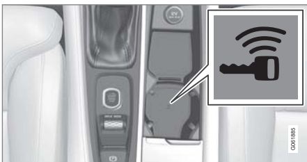
ตำแหน่งของตัวอ่านคีย์รอนในคอนโซลบริเวณโพงพลากลาง
