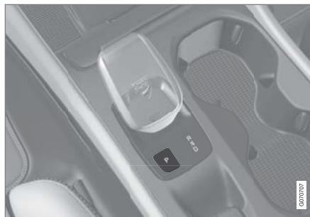
ภาพรวมของคันเกียร์และตำแหน่ง P สำหรับคันเกียร์ขนาดเล็ก
