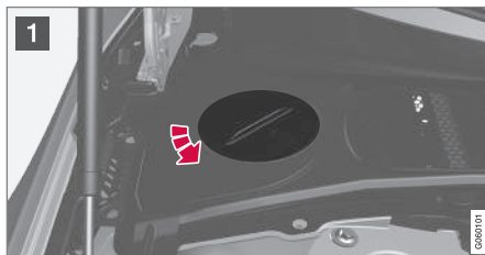
Расширительный бачок системы охлаждения, автомобиль с левосторонним управлением
