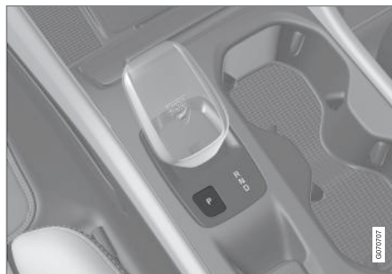
Рычаг переключения передач и положение P в автомобилях с компактным рычагом переключения передач.
