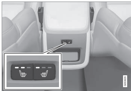
Кнопки сзади на тоннельной консоли для сидений с электрообогревом.
