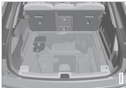
Если в автомобиле установлен вспомогательный аккумулятор 48 В, он находится в багажном отделении с левой стороны. Только персонал авторизованной мастерской допускается к работе со вспомогательным аккумулятором 48 В.
