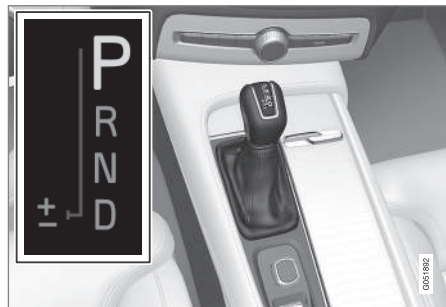
Вид высокого рычага переключения передач и схема переключения передач на дисплее водителя.
