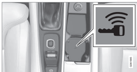
Резервное считывающее устройство в подстаканнике.
