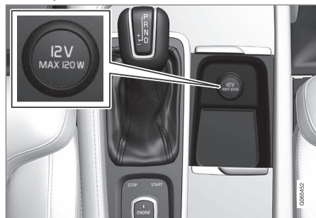
Электрическое гнездо 12 В в тоннельной консоли, передние сиденья.
