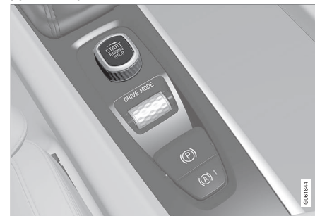
Ручка запуска в тоннельной консоли.
