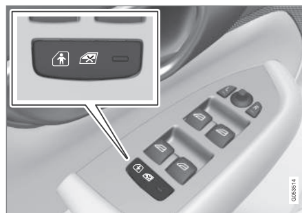
Кнопка для активирования и отключения электрической блокировки.
