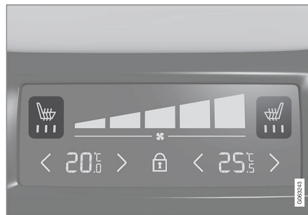
Индикация обогрева сидений и органы управления на панели климата сзади на тоннельной консоли.
