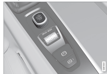
Ручка запуска в тоннельной консоли.
