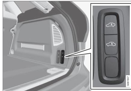
Регулятор для опускания/подъема задней части автомобиля.
