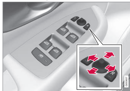
Управление внешними зеркалами заднего вида.
