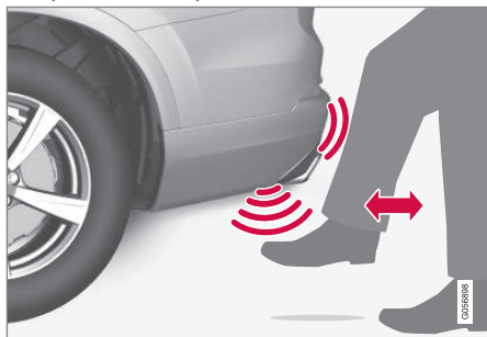
Мах ногой в пределах зоны действия датчика.
