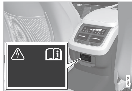
Электрическое гнездо в тоннельной консоли, заднее сиденье.
