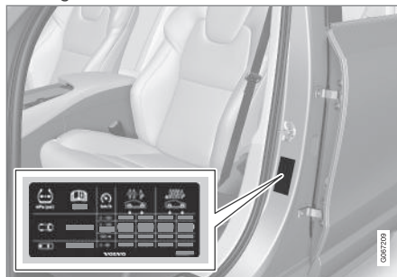
Localização do autocolante da pressão dos pneus
