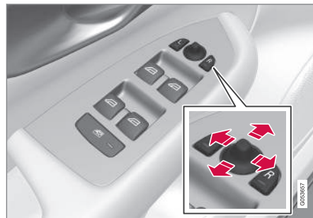
Comando dos retrovisores exteriores.
