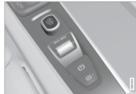
Disco de arranque na consola de túnel.
