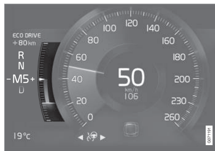
Medidor ECO no mostrador do condutor 8 polegadas.
