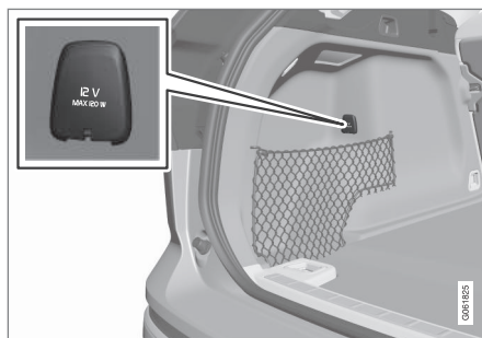
Tomada 12 V no compartimento da bagagem*.
