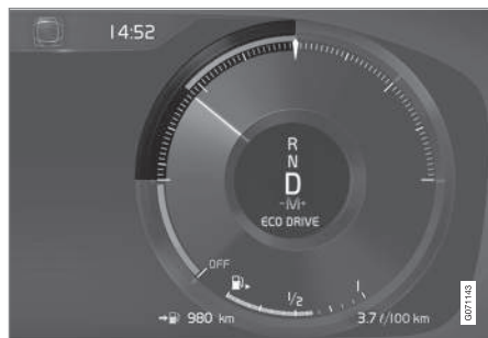
Medidor ECO no mostrador do condutor 12 polegadas*.
