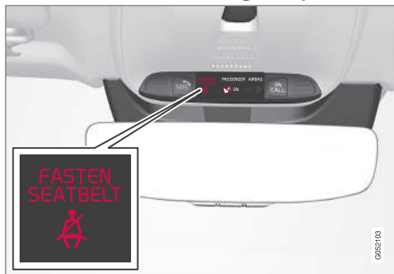
Aviso luminoso na consola do teto.
