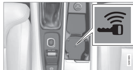
Localização do leitor no console de túnel.
