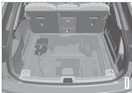
Jeśli samochód jest wyposażony w akumulator pomocniczy 48 V, jest on umieszczony po lewej stronie przestrzeni bagażowej. Akumulator pomocniczy 48 V może być obsługiwany tylko przez autoryzowany warsztat.
