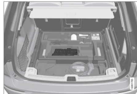
Akumulator rozruchowy znajduje się w przestrzeni bagażowej.
