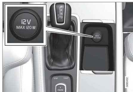
12 V strømuttak i tunnelkonsoll, forsete.
