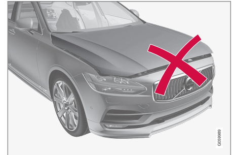
Panseret ikke helt lukket.
