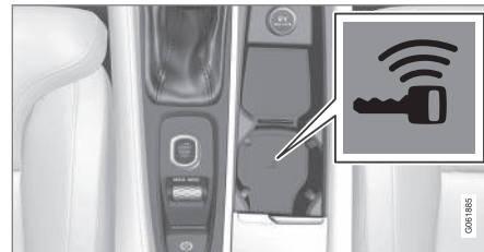
Positie back-uplezer in de tunnelconsole.
