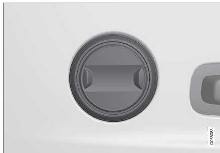
De bediening bij auto's met een lendensteun met tweewegverstelling*.
