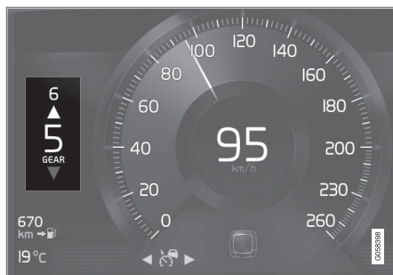
Schakelindicator op 8 inch bestuurdersdisplay.
