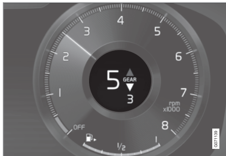
Schakelindicator op 12 inch bestuurdersdisplay*.
