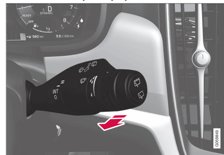
Sproeifunctie, rechter stuurhendel.
