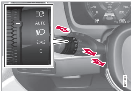
Stuurhendel met draairing.
