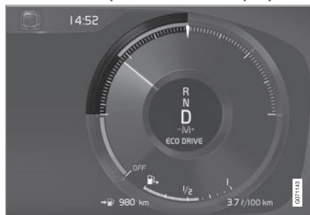
ECO-meter op 12 inch bestuurdersdisplay*.
