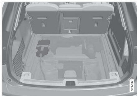
차량에 48 V 보조 배터리가 장착된 경우, 트렁크 좌측에 있습니다. 48 V 보조 배터리는 서비스 센터만 취급해야 합니다.
