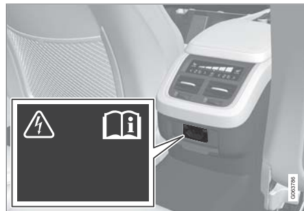
뒷좌석 터널 콘솔의 전원 소켓.
