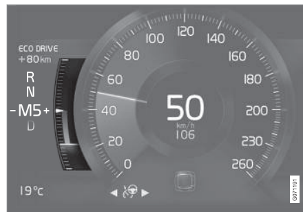
Misuratore ECO sul display del conducente da 8".
