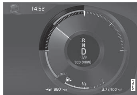
Misuratore ECO sul display del conducente da 12"*
