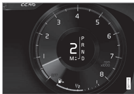
Display del conducente in caso di cambio marcia con le leve al volante in posizione di cambio manuale con leva selettore grande.
