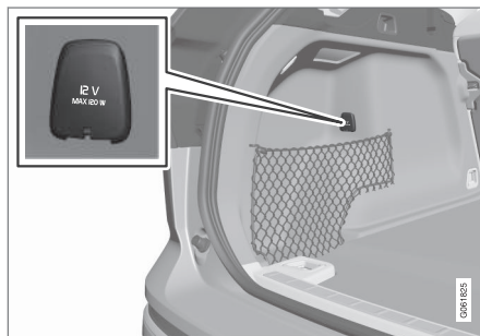
Presa elettrica da 12 V nel bagagliaio*.
