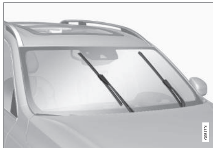
Spazzole tergicristallo in posizione di assistenza.
