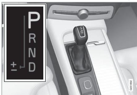
סקירה של ידית בורר ההילוכים גדולה ותיבת החלפת ההילוכים בצג הנהג.
