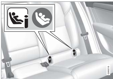
מיקומי נקודות העיגון מסומנים בסמלים 2 על ריפוד משענת הגב.
