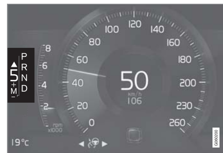
מחוון החלפת הילוכים בצג נהג 8 אינץ' עבור ידית בורר הילוכים גדולה.
