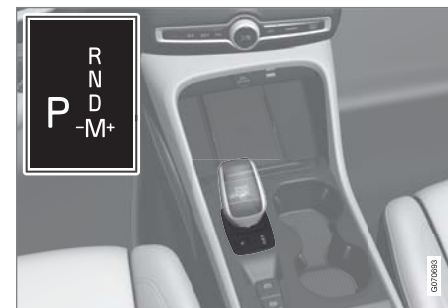
סקירה של ידית בורר הילוכים קטנה ותבנית החלפת ההילוכים בצג הנהג.
