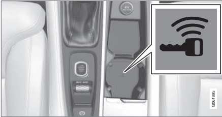
Emplacement du lecteur de secours dans la console de tunnel.
