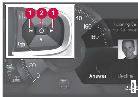
Exemples de messages du tableau de bord 4 et clavier placé à droite du volant de direction.
