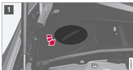
Δοχείο διαστολής ψυκτικού, αριστεροτίμονο αυτοκίνητο
