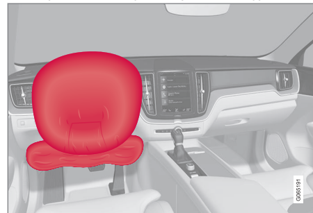
Αερόσακος τιμονιού και αερόσακος γονάτων 1 στο κάθισμα του οδηγού.
