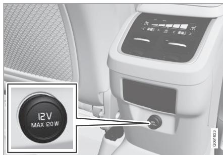
12-V-Steckdose in der Tunnelkonsole, Rücksitz.
