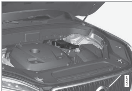
Die 12 V-Unterstützungsbatterie befindet sich in einem Gehäuse neben dem Federbeinturm.
