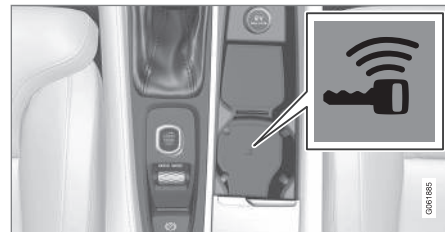
Lage des Schlüssellesegeräts in der Tunnelkonsole.
