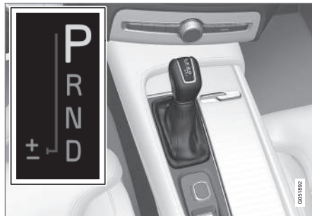
Oversigt over stor gearstang og gearskiftemønster på førerdisplay.
