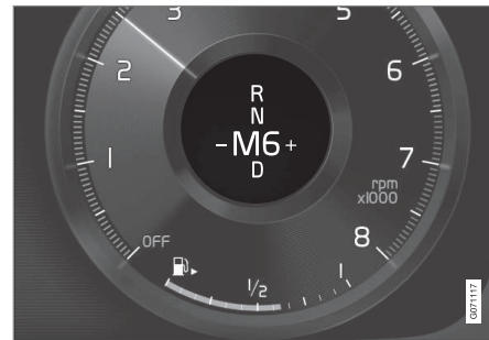
Gearskifteindikator på 12-tommers førerdisplay for lille gearstang*.
