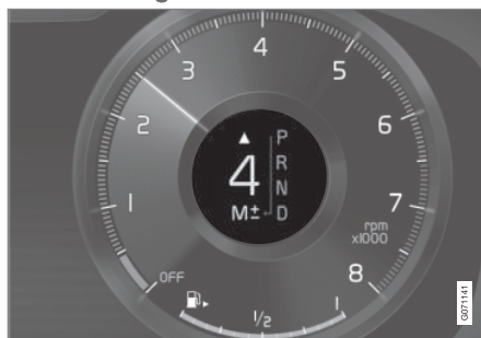
Gearskifteindikator på 12-tommers førerdisplay for stor gearstang*.
