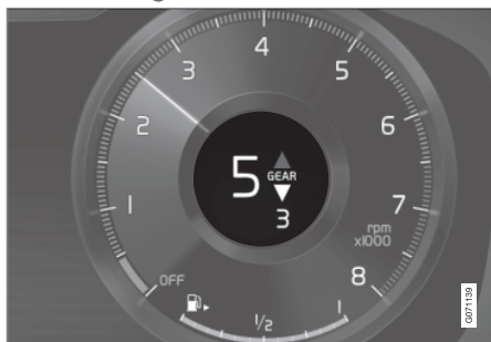
Gearskift-indikator på 12-tommer førerdisplay*.
