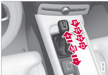
Oversigt over stor gearstang og gearpositioner.
