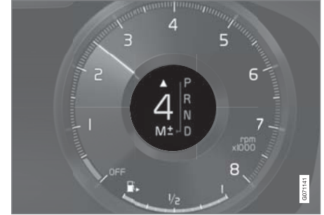
مؤشر تعشيق التروس في شاشة السائق قياس ١٢ بوصة، في حالة ذراع تغيير التروس الكبير.*
