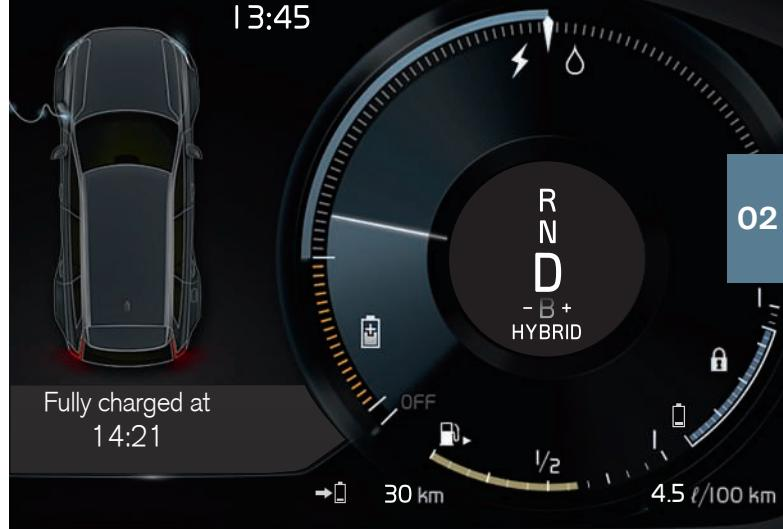
Cet indicateur montre le niveau actuel de charge dans la batterie hybride. Le courant électrique est également utilisé par la climatisation.
