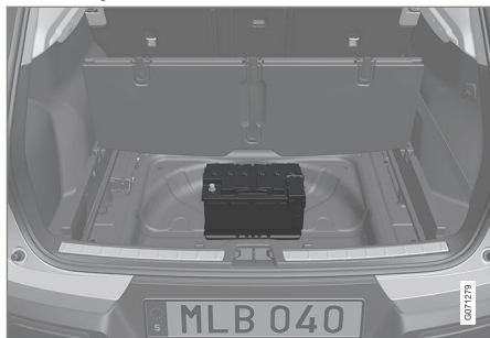
Стартерний акумулятор знаходиться в багажному відділенні.
