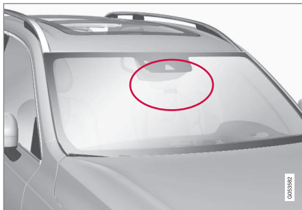
Расположение блока камеры
