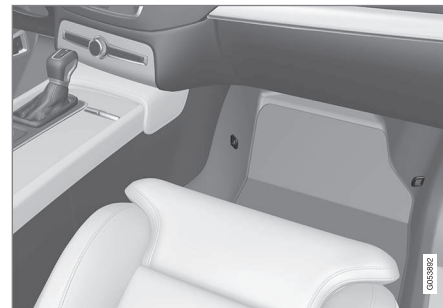
Расположение точек крепления для переднего сиденья.
