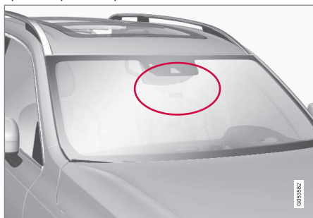
Положение радиолокационного блока
