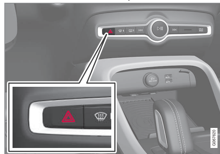
Buton pentru luminile de avarie.
