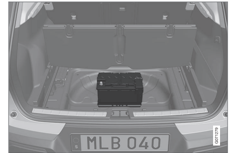
A bateria de arranque encontra-se no compartimento da carga.
