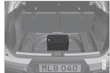
A bateria de arranque está na área de carga.
