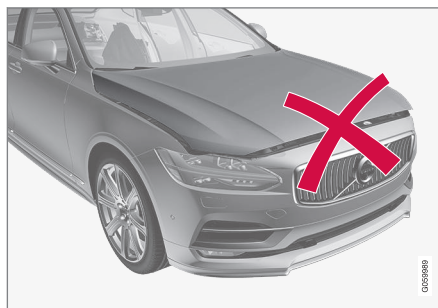
Capô não completamente fechado.
