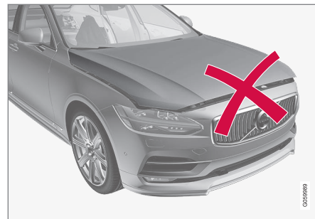
Niedomknięta pokrywa silnika.
