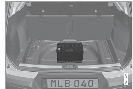
Akumulator rozruchowy znajduje się w przestrzeni bagażowej.
