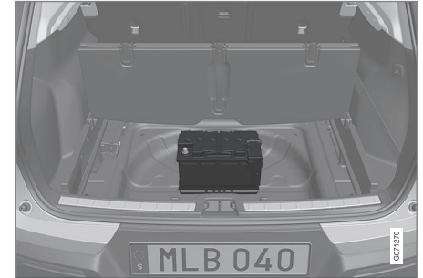
Startbatteriet sitter i bagasjerommet.
