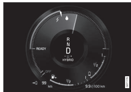
Bestuurdersdisplay bij aandrijving met elektromotor en verbrandingsmotor.
