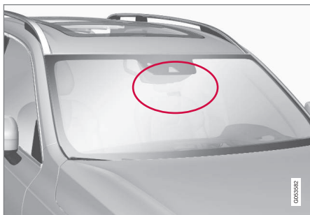
Positie van de camera-eenheid
