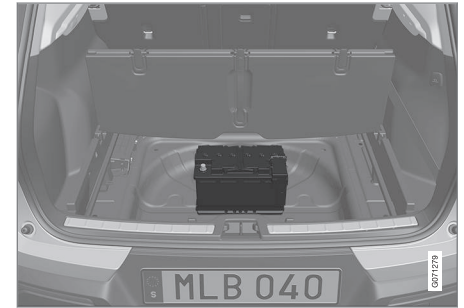
Startera akumulators atrodas bagāžas nodalījumā.
