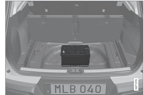
Starterio akumulatorius įrengtas bagažinėje.
