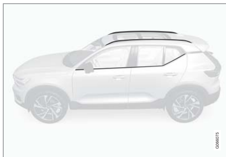
pH 値が 3.5~11.5 のクリーナーを使用して洗う必要のある箇所
