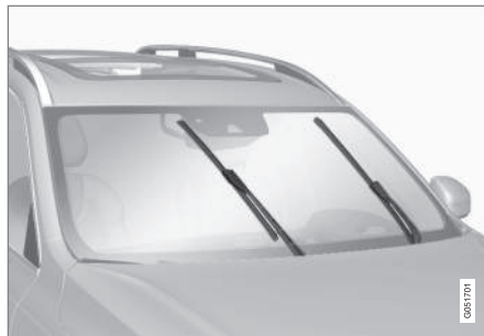
Spazzole tergicristallo in posizione di assistenza.
