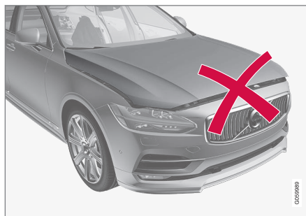
Cofano non completamente chiuso.
