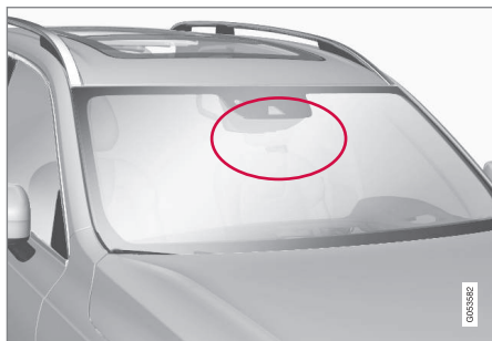
Ubicación de la unidad de cámara
