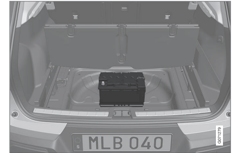
Die Startbatterie befindet sich im Kofferraum.
