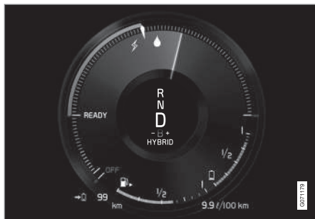
Displej řidiče pro pohon s elektromotorem a motorem s vnitřním spalováním.
