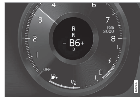
Indikace řazení na displeji řidiče 5 .
