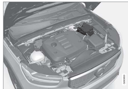
起動電瓶位於引擎室中。
