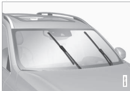
Torkarblad i serviceläge.
