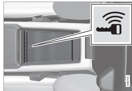
Расположение резервного считывающего устройства.
