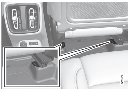
Расположение точек крепления для заднего сиденья.
