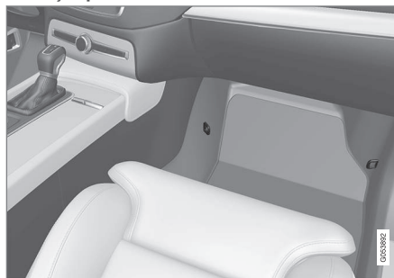
Locațiile punctelor de fixare pe scaunul față.
