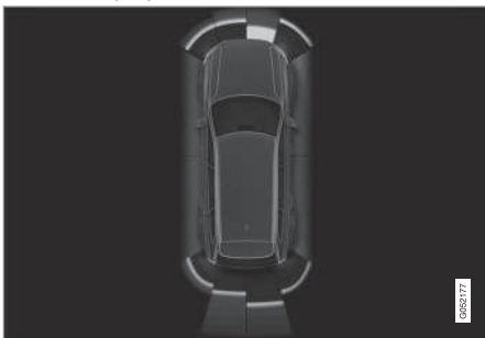
Beeldscherm met obstakelzones en sensorsegmenten.
