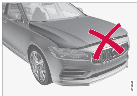
Cofano non completamente chiuso.
