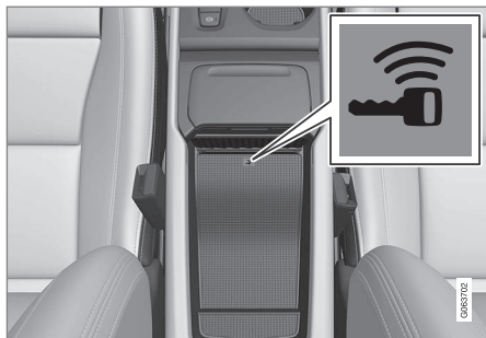
Emplacement du lecteur de clé de secours dans le compartiment de rangement.
