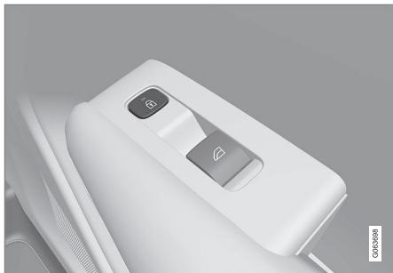
Låseknop med indikeringslampe i bagdør.
