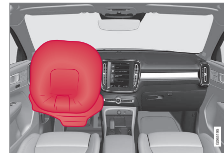
Rat-airbag og knæ-airbag 1 til forsædet i førersiden.
