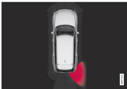
Tændt ikon for Cross Traffic Alert i billedskærmens Parkeringsassistent -grafik.
