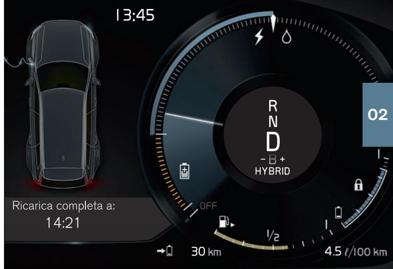
batteria ibrida si ricarica se il livello di carica è basso. **Hold** indica che il livello della batteria viene mantenuto per uso futuro.
